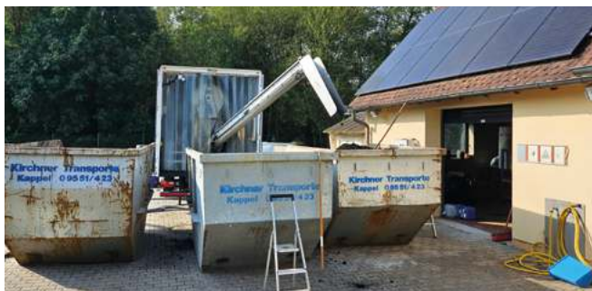
Abb. 4: Mit einer Förderschnecke werden die Absetzmulden befüllt.
