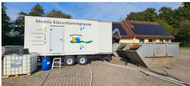
Abb. 2: Der Anhänger mit der Schneckenpresse, der von der jeweiligen Kläranlage beigestellte IBC mit dem Polymer und die drei Mulden zur Aufnahme des entwässerten Klärschlammes
